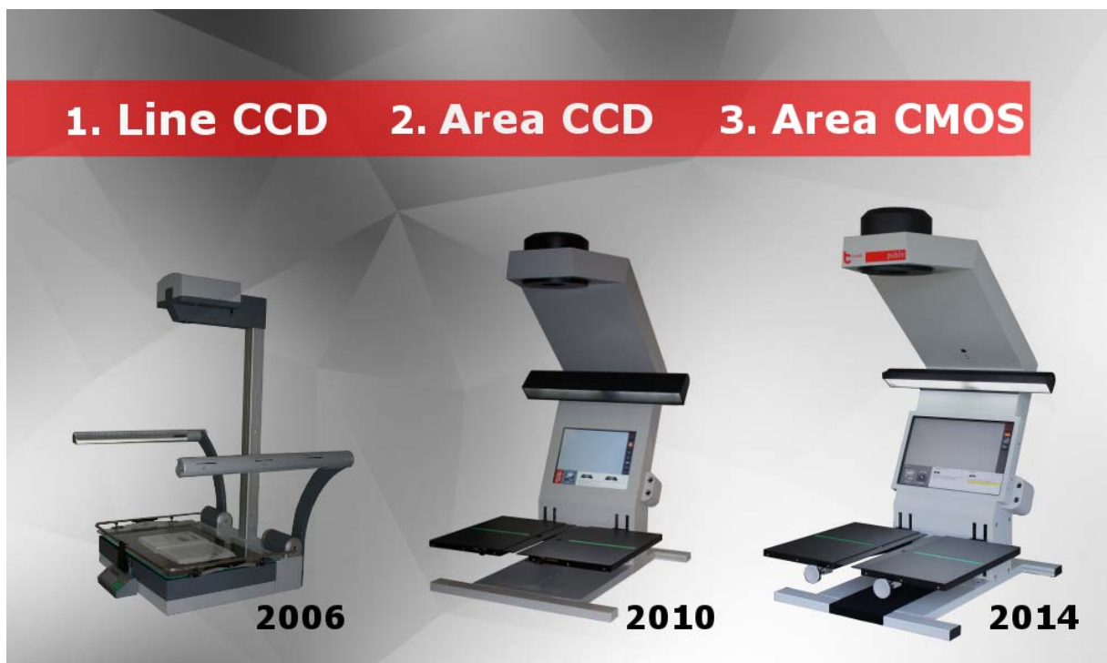
Rys. 3. Od lewej: skaner book2net RGB z liniowym sensorem CCD, skaner book2net kiosk z sensorem obszarowym CCD i monitorem dotykowym, skaner book2net kiosk II z sensorem obszarowym CMOS.
